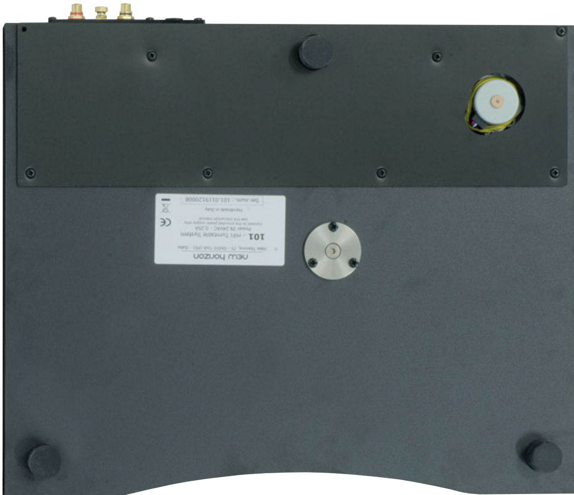
La vista inferiore del giradischi mostra come l'elettronica sia stata inclusa in uno scomparto scavato nel telaio e chiuso da un coperchio. Quest'ultimo prevede un'apertura per lasciare spazio al motore che è sospeso elasticamente. Il robusto perno centrale è fissato con tre viti.
