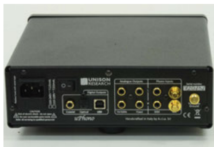
Dettaglio del pannello posteriore dell'Unison uPhono. Si notino le molteplici uscite digitali.
